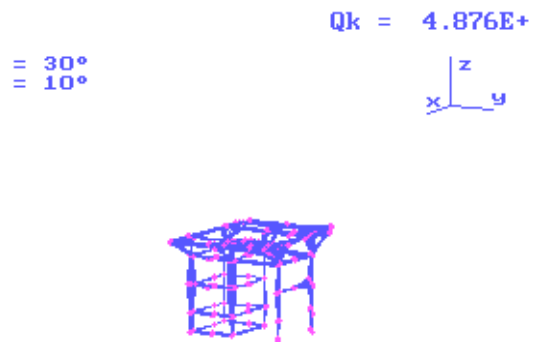
9. ábra Gépalap javítás utáni animációs rezgésképe ( Q_k=4,876 )
