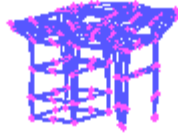
10. ábra Javítatlan, de jó állapotú gépalap animációs rezgésképe ( Q_k=4,876 )
